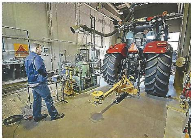
...sowie Hubkraft und Hydraulikleistung gemessen.
