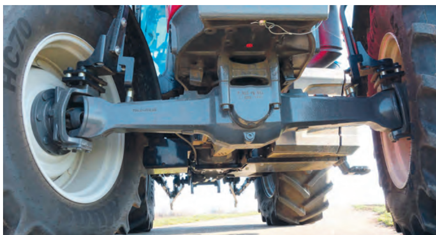
Auch beim N4 ist die Unterseite relativ glatt und hat hohe Bodenfreiheit. Das ist gut im Wald (optionale Schutzplatte) und gut auch in wachsenden Beständen im Pflanzenbau.
