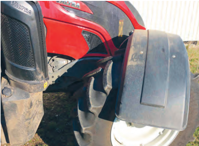
Die vorderen Kotflügel sind drehbar und bieten eine Wartungsposition für bessere Zugänglichkeit zum Motor.
