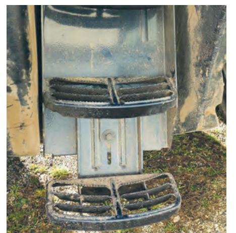
Sicherer und breiter Aufstieg mit höhenverstellbarer unterer Stiege
